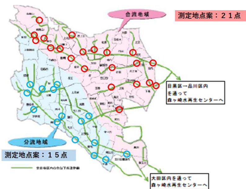
Fig.4 世田谷区の幹線下水道に設けた取水点例、株式会社 NJS による (世田谷区 HP 情報に書き足し)
