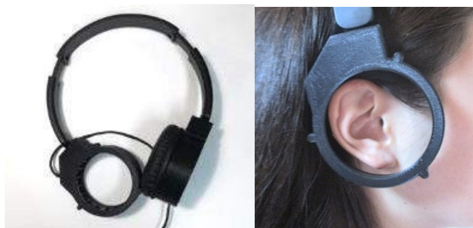
Fig.5 piezo・アクチュエータを搭載した聴覚ARデバイス(左)とその装着姿(右)
