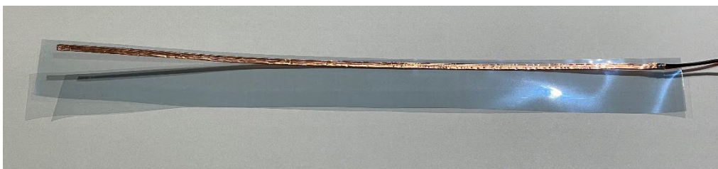
Fig.4 導電性ナノシートが両面積層されたpiezofilmを用いて作成した 導電性高分子piezo・アクチュエータ
