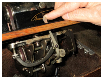
Fig.7 蝋管蓄音機はレバーの操作により、回転速度を落として再生する事が出来る。
