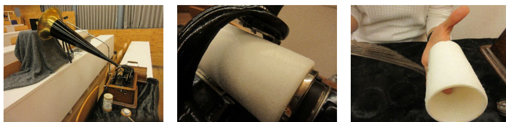
Fig.10 録音状況と、録音直後の蝋管の状態、削り屑の除去
