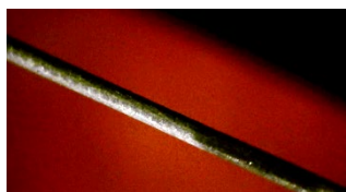
Fig.9 バイオリンのスチール弦 (A 線) 直径 0.87mm
