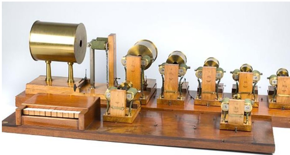
Fig.3 ヘルムホルツの母音音叉 (20 世紀になって作り直されたもの) 左手前に見える鍵盤を「演奏」して、異なる母音が「和声」として響く
